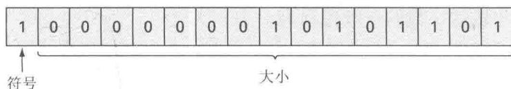
图4.2 十进制数-173在16位计算机上用符号量值法的二进制表示
